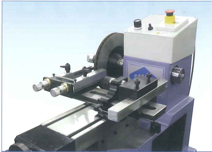
ディスク切削 (送り方向はスピンドルに対して垂直)
