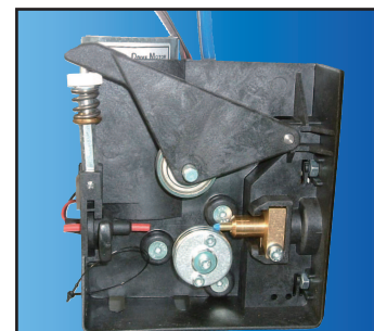
ワイヤ送りスピードを手元でコントロール
