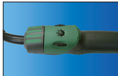
ワイヤ送りスピードを手元でコントロール
